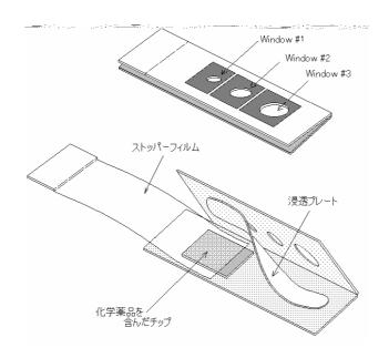
まず、ストッパーフィルムを引き抜き、化学薬品を含んだチップと浸透プレートを接触させます。一定の温度を超えた状態に置かれると、チップ中の化学薬品が溶けて浸透プレートに染み込み、設定された速度で変色していきます。温度が反応温度以下になると、化学薬品の 浸透は止まります。
